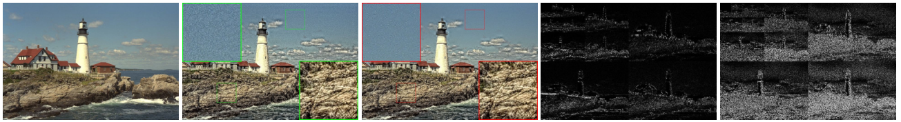
(a) 入力画像 (768×512) (b) 提案強調 (c) PA 提案強調 (d) WT 係数 (sin, K = 1 ) (e) WT 係数 (sin, K = 6 ) 図 9 パラメータアダプティブ (PA) 拡張結果 ( \sigma_r = 20, \ell_{\max} = 4, K = 6, m = 5 )
