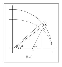
移動する (360 / 365.2422 => 0.98564733). 第1項の 280.4665 は d で 2000 年 1月1日の JD を引いていることからその基準日の太陽黄経.  $\omega$  は近日点の黄経. その L との差が M. これを面積速度一定の楕円軌道に修正をする ( $S' \to S''$ ). その角度が E で M から Newton 法で解く. E の初期値を適当に決め,  $E' = E - \frac{E - e \sin E - M}{1 - e \cos E}$  を繰り返す. ここだけは弧度法で計算する. E が決まれば V が得られる.
